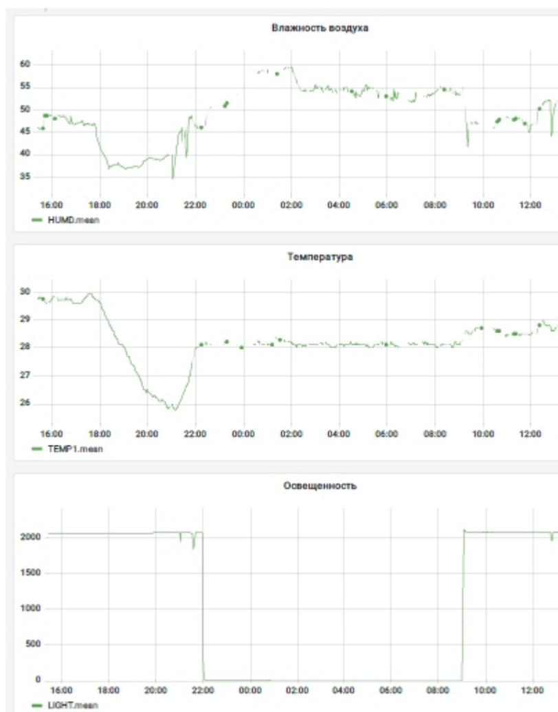
Рисунок 5 – Графики показаний с датчиков теплицы
