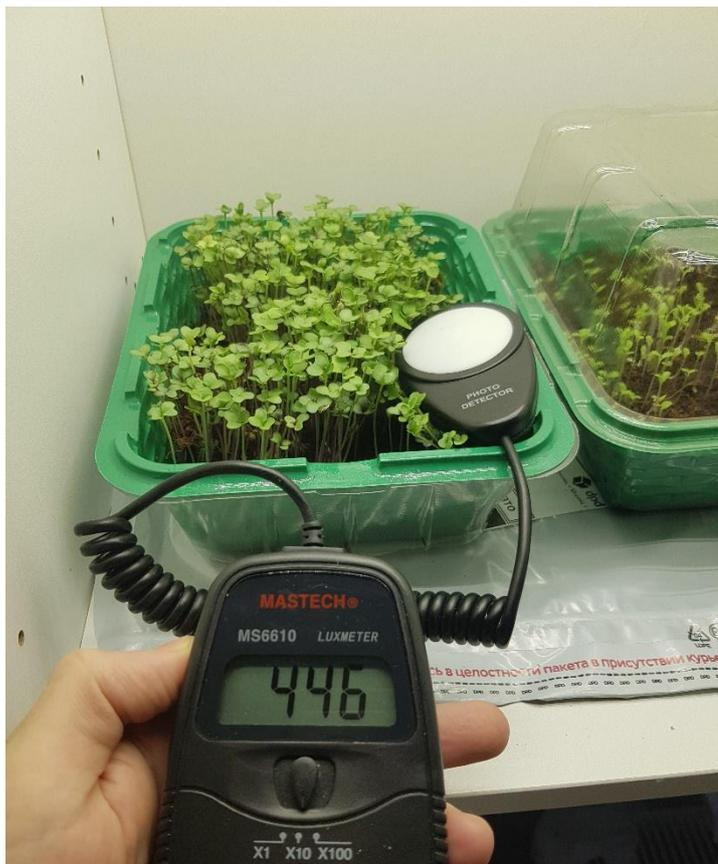
Рисунок 3 – Измерение освещенности в теплице
